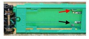
Nun geht es an die Innenbeleuchtung, die über einen Tran DCX32 Funktionsdecoder angesteuert wird. Durch den Funktionsdecoder kann die Beleuchtung individuell über Funktionstasten F1 Innenbeleuchtung Triebwagen mit Motor und F2 Innenbeleuchtung Triebwagen ohne Motor geschaltet werden.
