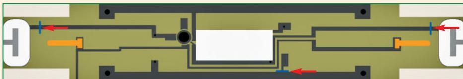
Die Platine, nachdem die Bauteile entfernt wurden.
