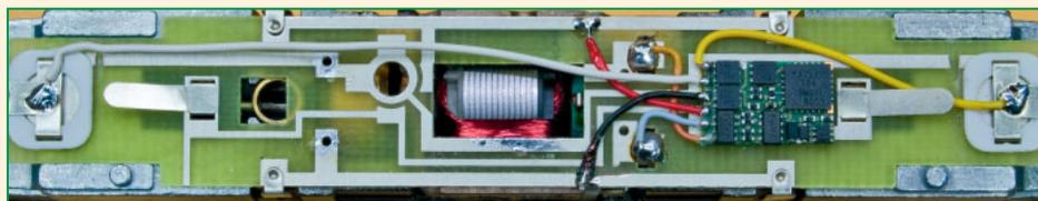
Die Original-Platine mit dem Decoder und den angelöteten Kabeln.
