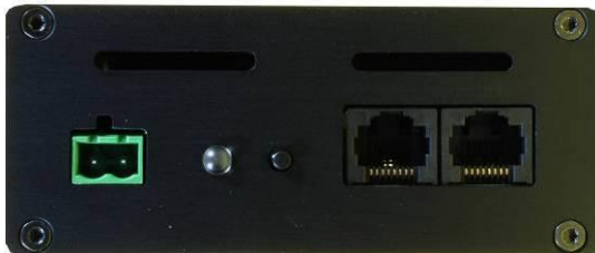
Anschlüsse Eingangsseite des \mu Con-Boosters v.l.n.r.: Netzteil =/-, Info-LED, Programmier-Taster, \mu CON-Bus Eingang und Ausgang
