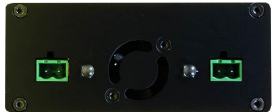
Anschlüsse Ausgangsseite des \mu Con-Boosters v.l.n.r.: Anschluss Gleis B, Info-LED Gleis B Anschluss Gleis A, Info-LED Gleis A
