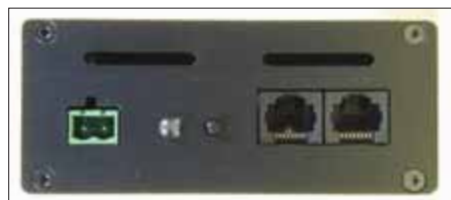
Anschlüsse Eingangsseite des μCon-Boosters; von links nach rechts: Netzteil =/-, Info-LED, Pro-grammier-Taster, μCON-Bus Ein- und Ausgang.
