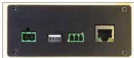
Anschlüsse Eingangsseite des μCon-Managers; von links nach rechts: Netzteil =/-, 5-pol. Booster-Bus, CDE-Bus, Ethernet-Anschluss (LAN).
