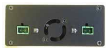
Anschlüsse Ausgangsseite des μCon-Boosters; von links nach rechts: Anschluss Gleis B, Info-LED Gleis B, Anschluss Gleis A, Info-LED Gleis A.
